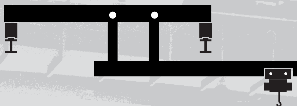
gru a ponte sospeso con trave sfilabile
