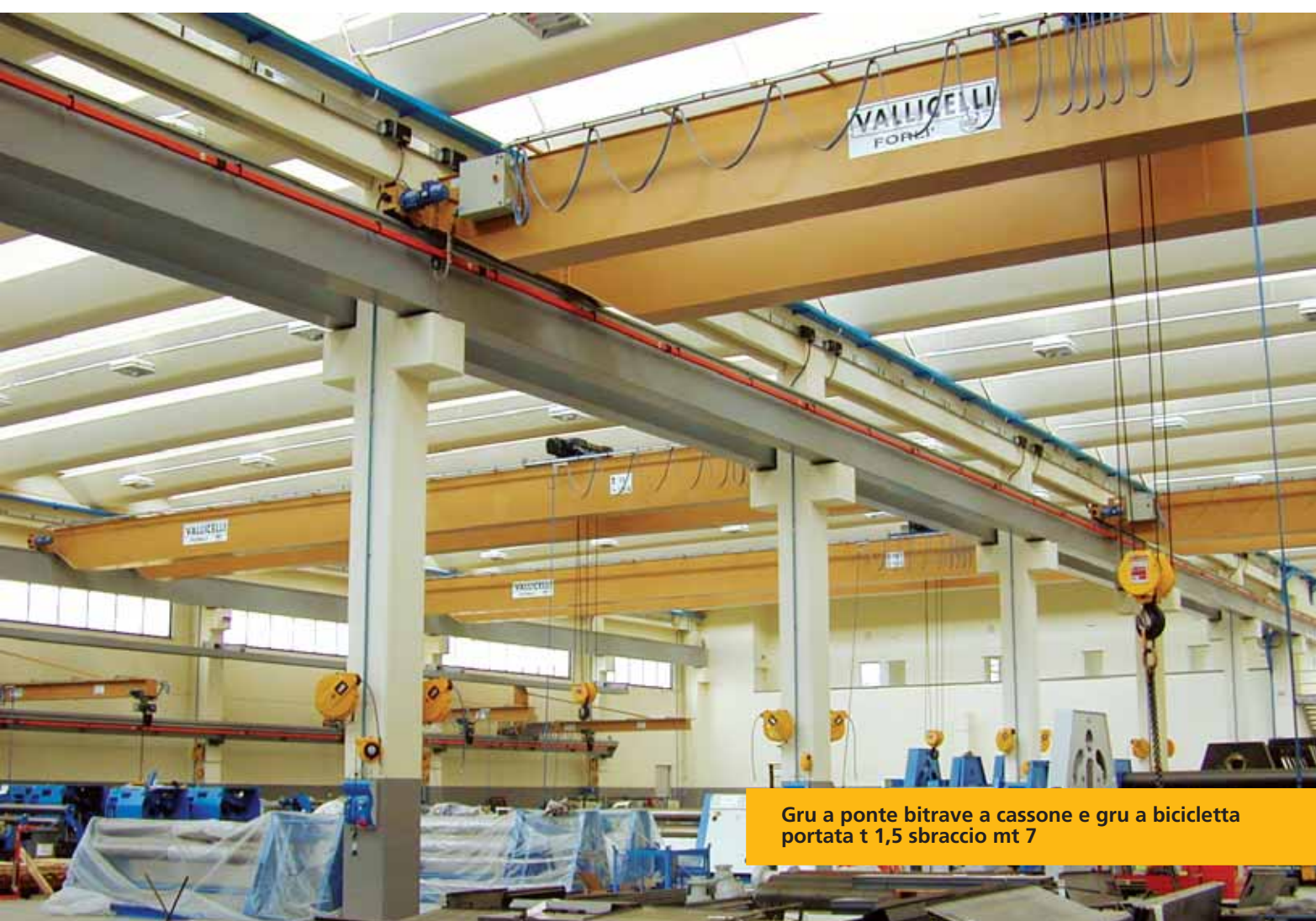
Gru a ponte bitrave a cassone portata t 16 scartamento mt 18,6 con carrello rotante più bilanciere con interasse ganci mt 5
