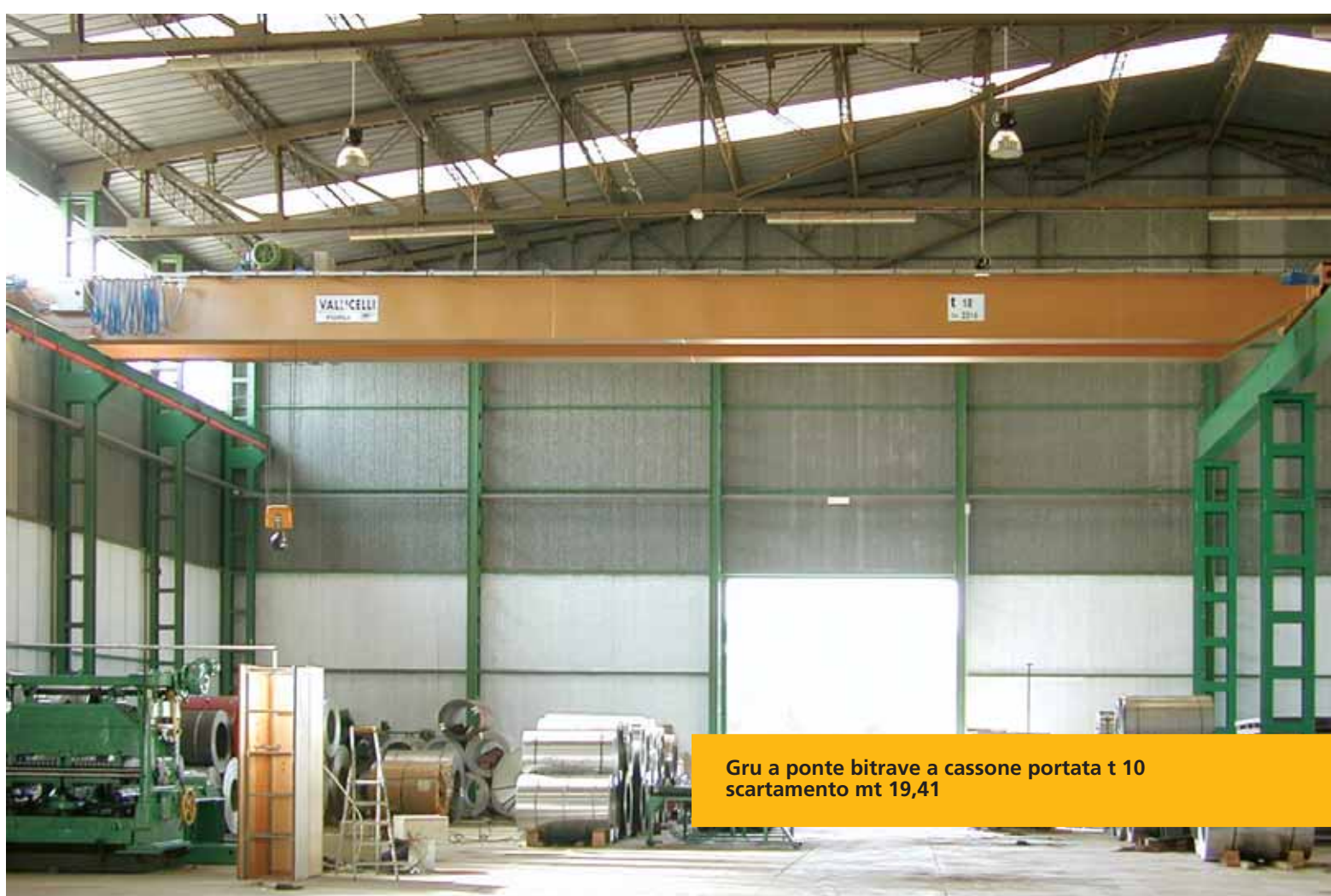
Gru a ponte bitrave a cassone portata t 10 scartamento mt 14,20. Gru a ponte bitrave a putrella portata t 6,3 scartamenti mt 6 e mt 4,2
