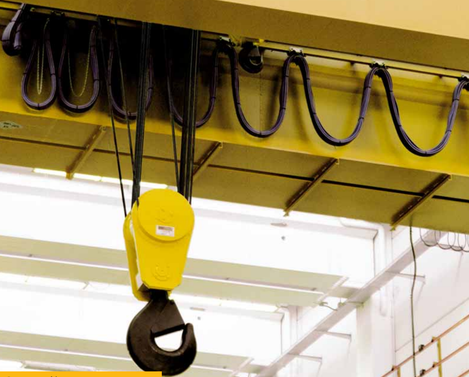
Gru a ponte bitrave a cassone portata t 140/25 scartamento mt 20,65
